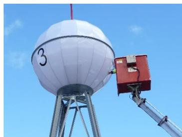
Positionné en haut de son mat, à une hauteur de 8m, un **LumiSphère** contenant 4 lampes de 1000W fournit un niveau d'éclairage de 11 lux à 55m (zone circulaire de 10 000m<sup>2</sup>)
